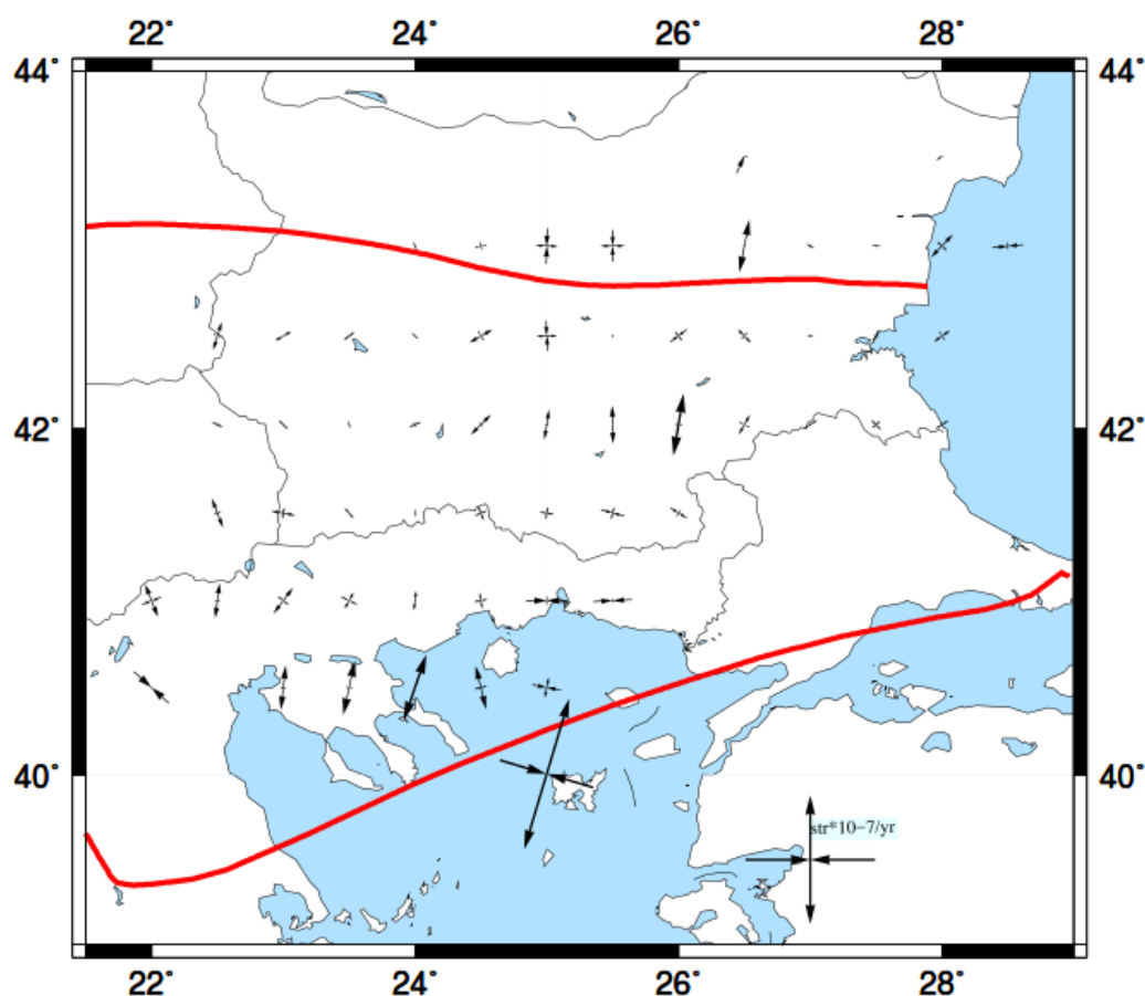
Фиг. 5.2.5. Напрежения на земната кора (strain rate), получени от хоризонтални скорости чрез GPS измервания от фиг. 5.1.3. (Solakov et al., 2015), (Георгиев, частна кореспонденция).
