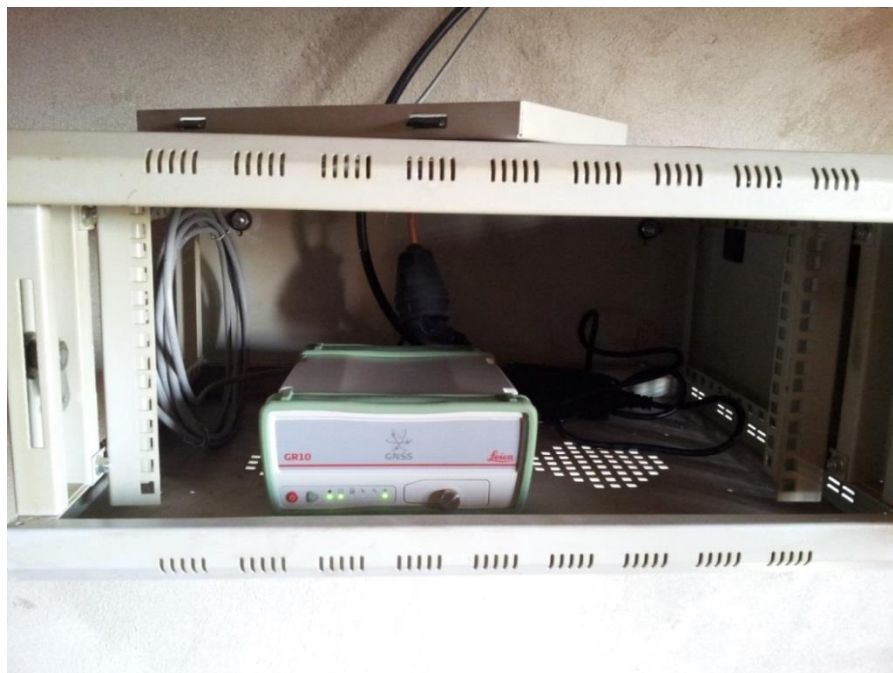
Фиг 12. GNSS перманентен приемник Leica GR10 инсталиран в гр. Перник
