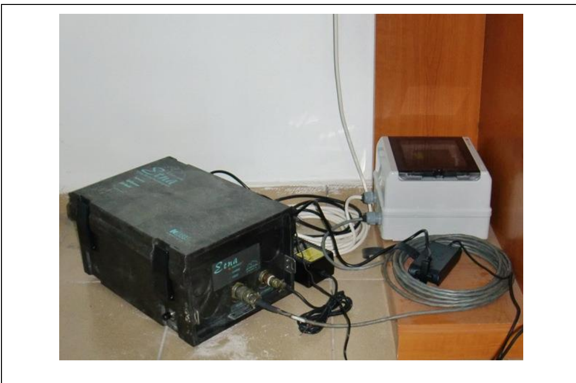
Фиг. 29. Инсталиран акселерограф “ETNA” #6558 и оборудване на ст. PER.
